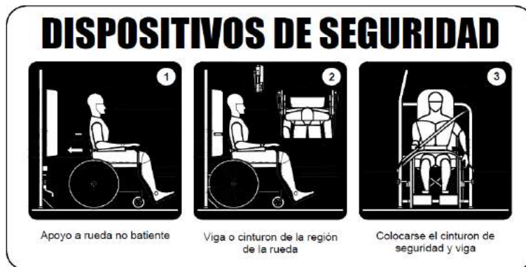
Figura 27. Orientación de fijación de la silla de ruedas y el cinturón de seguridad
