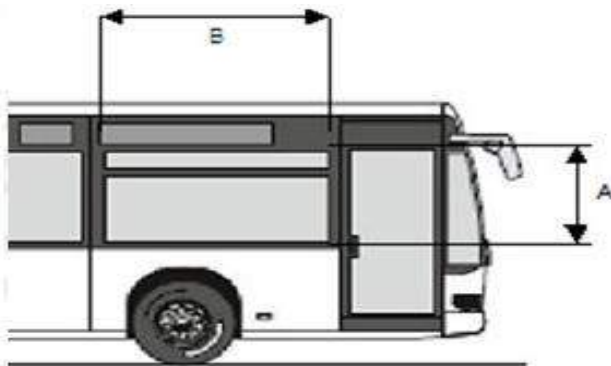
FIGURA 5. SALIDAS DE EMERGENCIA
